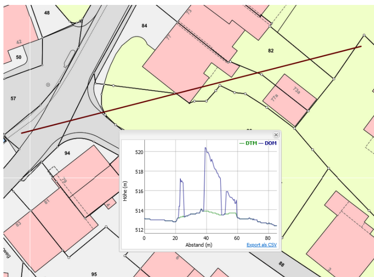
Abbildung 17: Terrainsprünge östlich der Hauptstrasse
